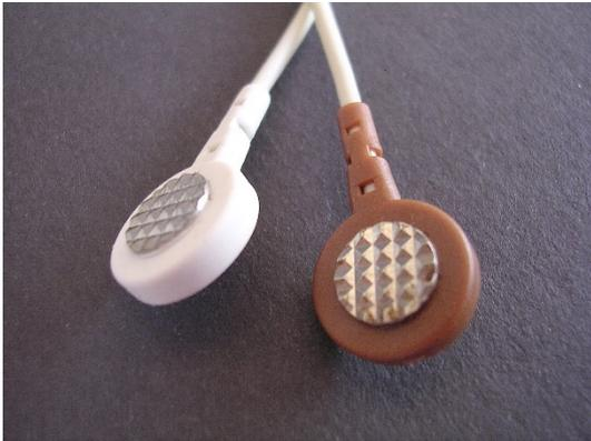
Die Oberflächen-Ableitelektrode dient zur Ableitung von motorischen und sensiblen Reizantwortpotentialen. Sie besteht aus zwei flachen geriffelten V2A -Stahlelektroden mit 8mm Durchmesser, die fest mit einem hochflexiblen 12/120 cm langen Kabel vergossen sind. Die weiße ist die aktive und die braune die Referenzelektrode.
