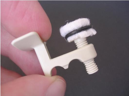
Gesinterte Silber/Silberchlorid Elektroden eignen sich hervorragend zum Einsatz bei Routine-Ableitungen, da sie nicht polarisierbar sind und somit auch den niedrigen Frequenzen kaum Widerstand entgegensetzen. Daraus resultiert eine Minimierung der Signalverzerrung. Zudem entfällt die ständige mechanische, chemische oder elektrolytische Reinigung und Neuchlorierung.
