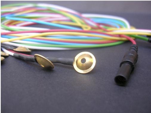
Die vergoldeten Napfelektroden aus Silber sind für alle Ableitungen evozierter Potentiale an Kopf, Nacken und Erb'scher Punkt geeignet. Da Silberelektroden polarisierbar sind, setzen sie niedrigen Frequenzen unter 10 Hz einen hohen Widerstand entgegen, so dass ein unerwünschter Drift ausbleibt. Die Goldschicht verhindert eine Oxidierung des Silbers, woraus eine längere Lebenszeit der Elektrode resultiert. Die von uns angebotenen Elektroden
