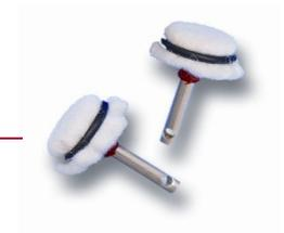
Die gesinterten Silber/Silberchlorid Oberflächenklebeelektroden werden ebenfalls zur Routine-Ableitung eingesetzt. Die eigentliche Elektrodenfläche, die einen Durchmesser von 4 mm besitzt, ist in einen Hart-PVC Ring eingebettet, dessen plane Oberfläche als Auflagefläche auf der Haut genutzt wird. Durch das geringe Eigengewicht der Elektrode ist diese besonders gut mit einem Klebeleitgel zu befestigen.
