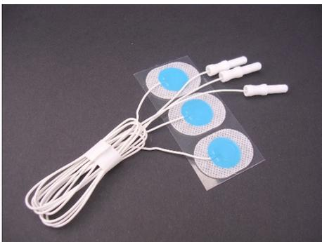
Die Blue Sensor Klebeelektrode ist eine häufig eingesetzte Silber/Silberchlorid Elektrode, die sich durch sehr gute Ableiteigenschaften auszeichnet. Sie ist mit einem leitfähigem und haftendem Hydrogel beschichtet, so dass kein weiteres Leitgel oder Haftpapier mehr benötigt wird. Der Aufzeichnungsbereich dieser Elektrode beträgt 9 x 6 mm. Eine sehr hochwertige Alternative zu den Blue Sensor Elektroden bieten die Neuroline Klebeelektroden. Die Neuroline 720 besitzt
